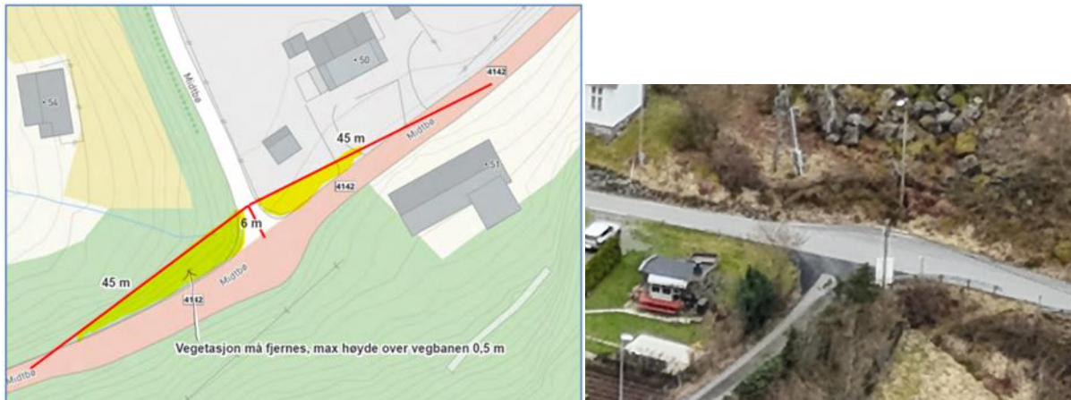
Figur 14: tv: Situasjonsplan for utbedring av utkjørsel hentet fra vedtaksbrev om avkjørselstillatelse. T.h: Utsnitt av dronefoto som viser utbedret utkjørsel fra området.
