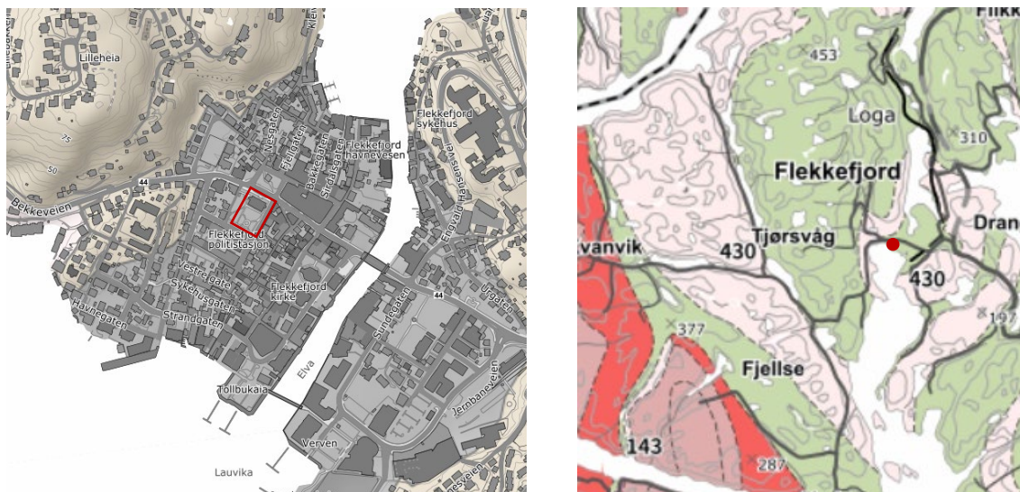
Figur 16: Til venstre vises mørkegrå område løsmasser som består av fyllmasser. Til høyre vises berggrunn at planområdet består av båndgneis (grønn farge). Planområdet markert med rød firkant til venstre og sirkel til høyre. Kartkilde: Geo.ngu.no
